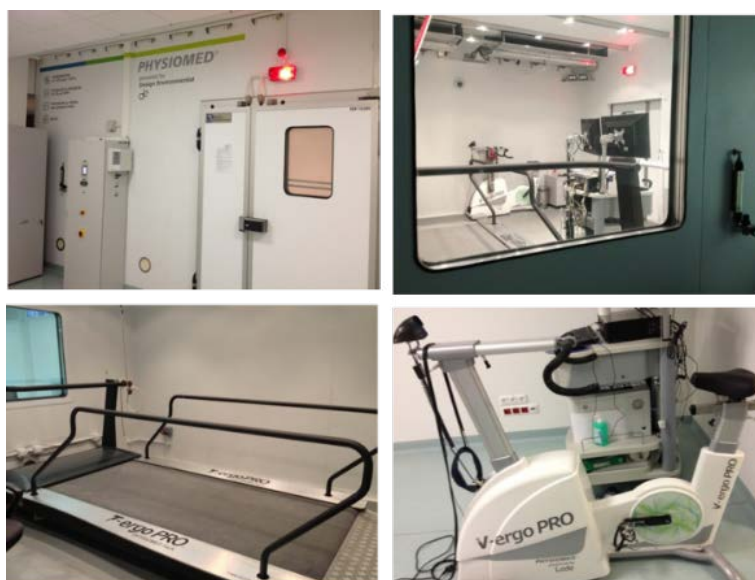
Рисунок 1 – Внешний вид климатической комнаты с установленной беговой дорожкой и велоэргометром
